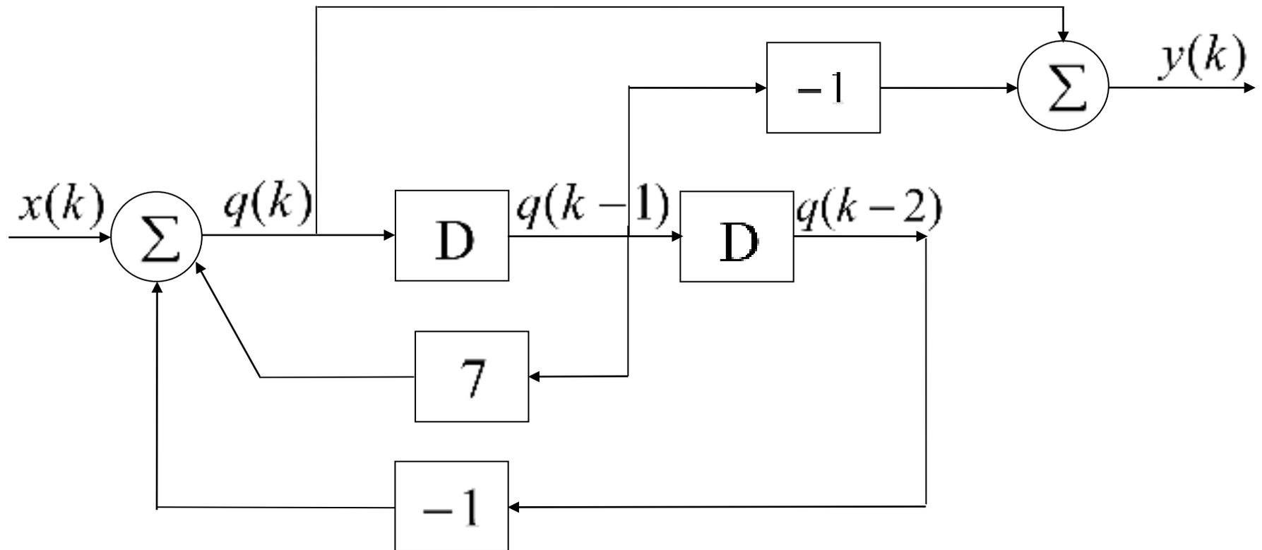
例 求图示离散系统的函数响应和单位阶跃响应。
