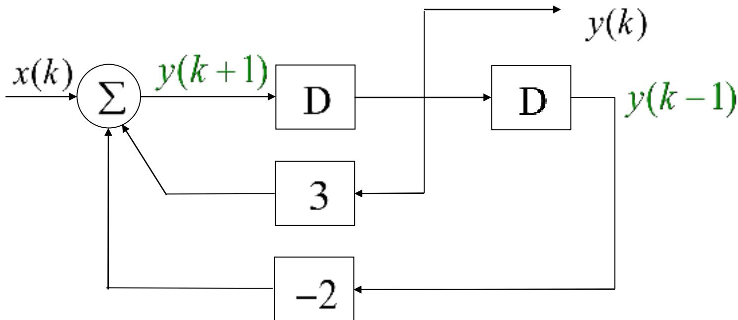
解：由模拟图知，加法器的输出为 $y(k+1)$ ，另一延时器的输出为 $y(k-1)$ 。
