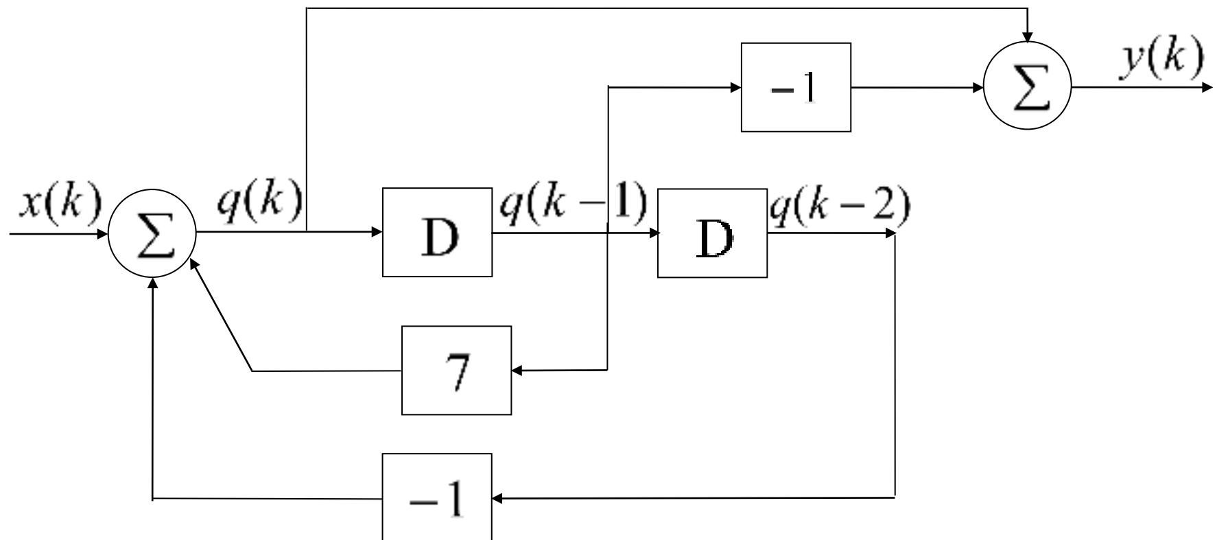
例 求图示离散系统的函数响应和单位阶跃响应。
