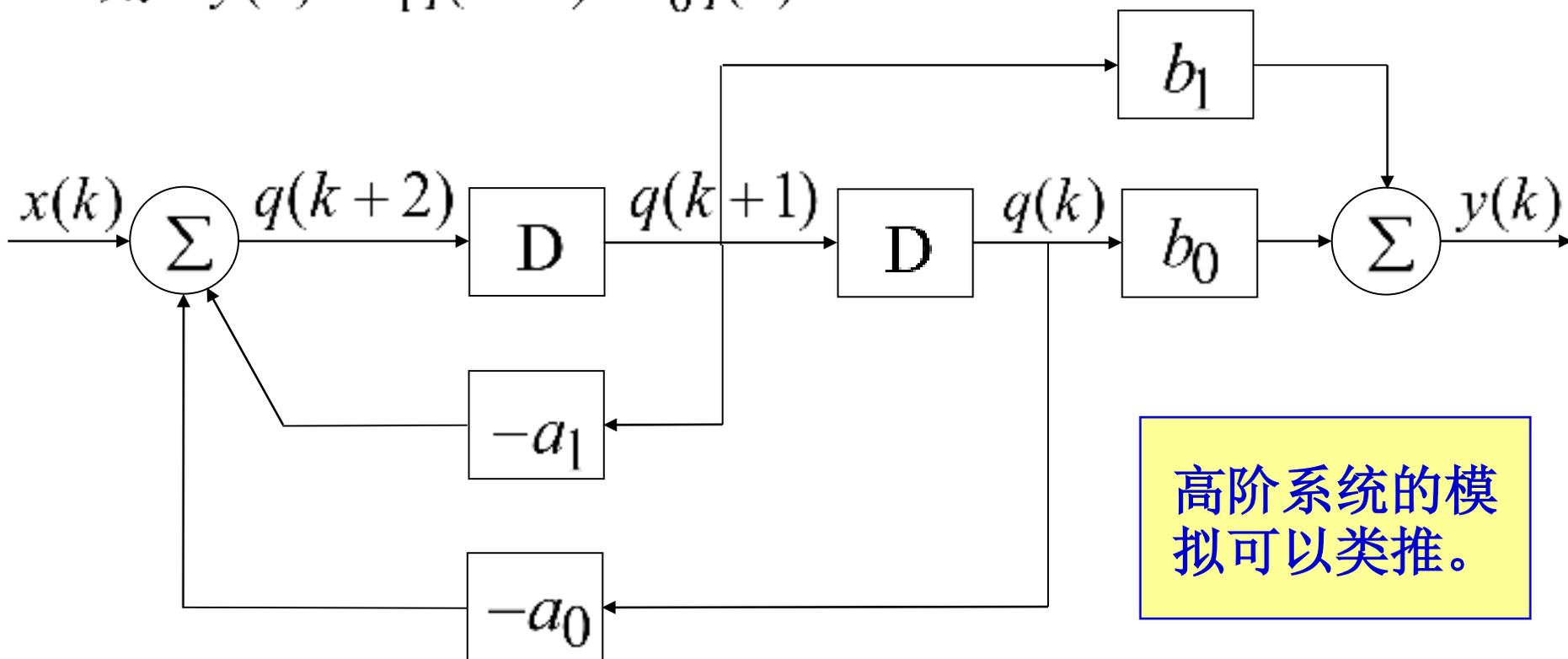
例：某离散系统如图所示，试写出其差分方程。
